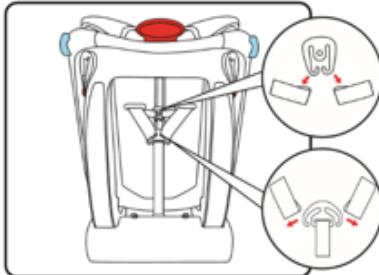
Korak 3: Uklonite dvije trake remena s metalnog dijela za spajanje.
