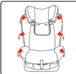
Korak 8: Uklonite pločicu slijedeći smjer strelica.
